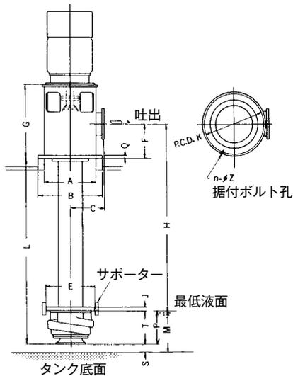
下表の“S”及び“M”は標準寸法を示しています。顧客によりL、O、タンク深さが選定される場合、軸長が2500mm以下になる可能性があります。その場合、“S”及び“M”寸法は1mmから100mmの範囲で変更されます。
