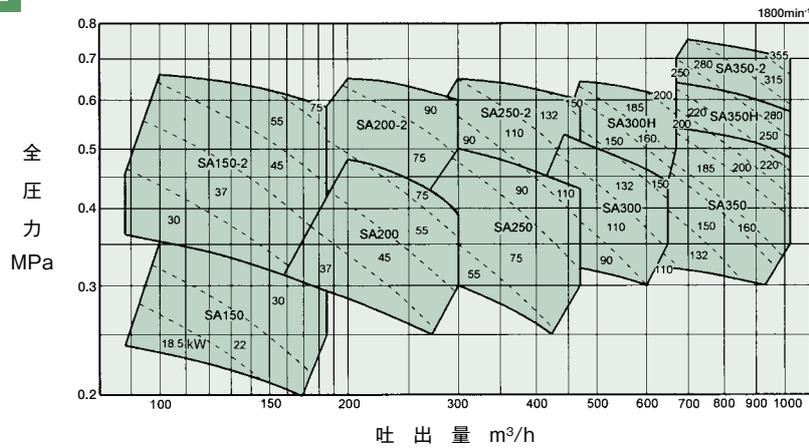
チャート内の破線で囲まれた範囲の数字は下記条件における駆動機の出力を示しています。
